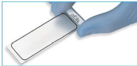
Figure 4 : Sortir la GASKET SLIDE de son emballage
