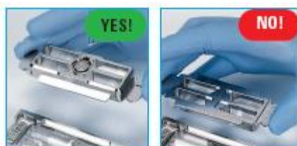
Figure 8 : Mise en place du couvercle de la chambre
